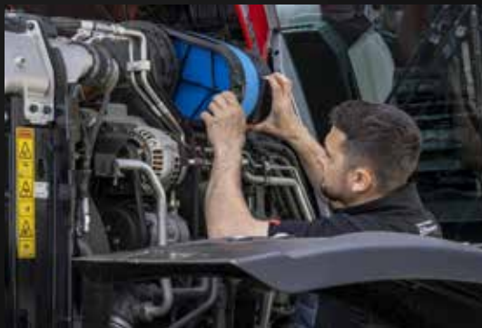
A motor légszűrője könnyen hozzáférhető és tisztítható.
